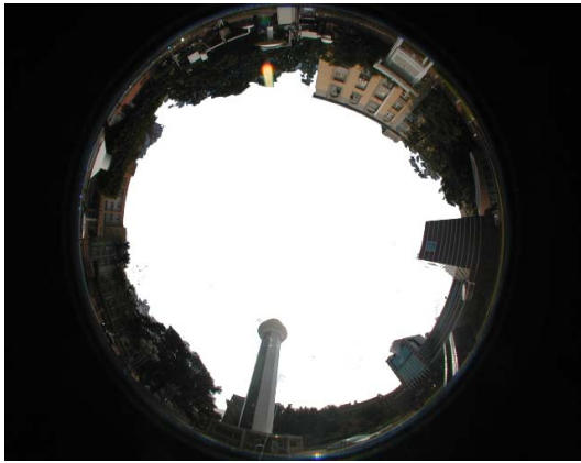
中央氣象局台北氣象站觀測坪 天空魚眼影像與環境遮蔽度 23.24^\circ (sky view factor: \sim 78\% ) (2016年3月3日中午拍攝)
